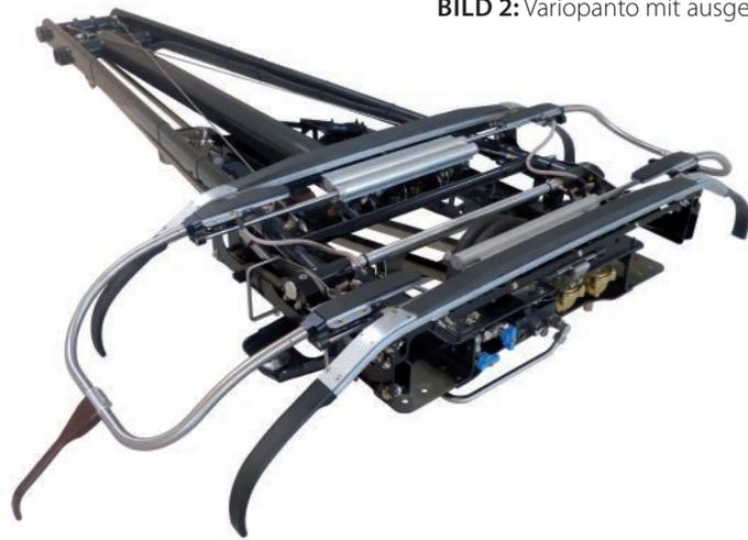
verstellung und der Variopanto darf in der neuen Breite an den Fahrdrabt gehoben werden. Diverse Sicherheitsaspekte sind berücksichtigt und in der Wippe sowie der Ventilplatte integriert. Hierzu zählen u.a. die Verriegelung der eingestellten Wippenbreite während des Betriebes in Hub- und Senklage sowie Mechanismen zur Abfrage der gewählten Wippenbreite. Mit dem Heben wird die pneumatische Schleifstück-Überwachung (ADD) wirksam. Im Falle der breiten 1950 mm Wippe gilt dies neben des »
